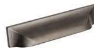
Maniglia 585 finitura acciaio ossidato semiopaco anta L 15 → passo 64 mm anta da L 30 a L 120 → passo 160 mm
