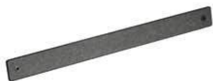
Maniglia 575 finitura ferro anta L 15 → passo 64 mm anta da L 30 a L 45 → passo 192 mm anta da L 60 a L 120 → passo 320 mm
