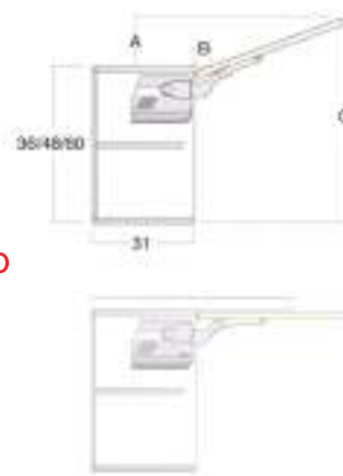
SCHEMA MONTAGGIO LIMITATORE PER RIBALTA H 36 FLAP DOOR LIMITER INSTALLATION DIAGRAM H 36
